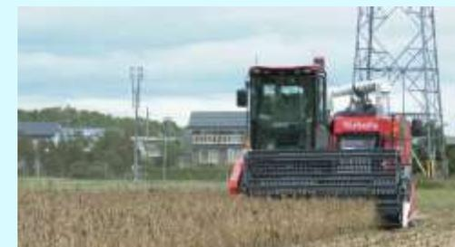
自動運転アシスト機能付きコンバインによる収穫作業
