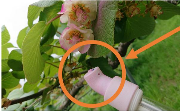
マイナスの高電圧を印加させ、ブラシ周辺にマイナスイオンを発生させる。花粉を空気圧で通過させるとマイナスの静電気が帯電する。
