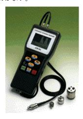
図-4 超音波厚さ計の一例
