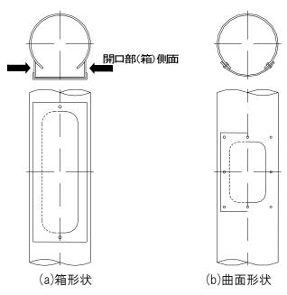
図-7 電気設備用開口部の形状
