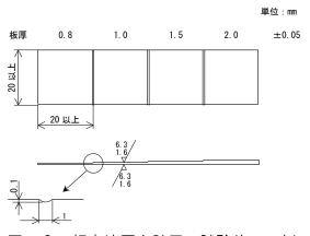
図ー6 超音波厚さ計用の試験片の一例
