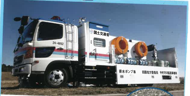
排水ポンプ車(高揚程型[揚程20m型] 30(15)ml/min軽量水中ポンプ搭載車)
