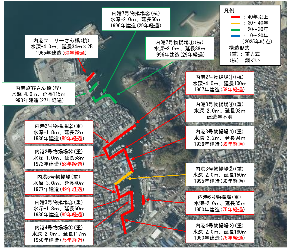
図 2.44 老朽化状況（内港地区）
