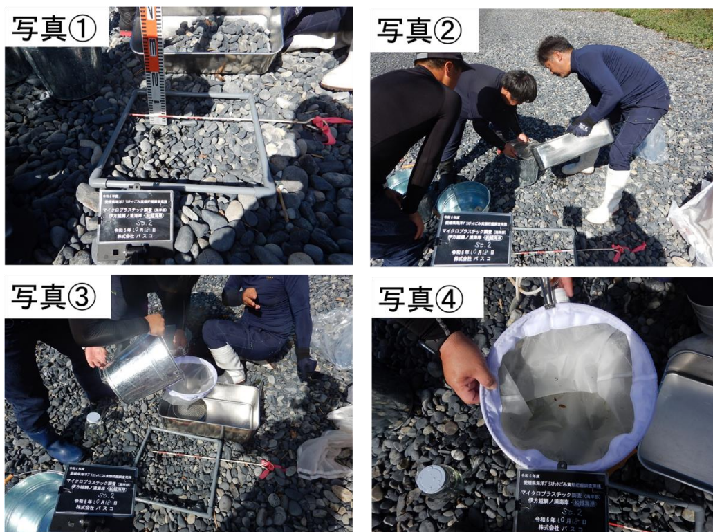
写真 2-4-2 マイクロプラスチックの採取方法
