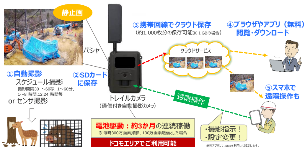
図 2-4-3 固定カメラ運用のイメージ
