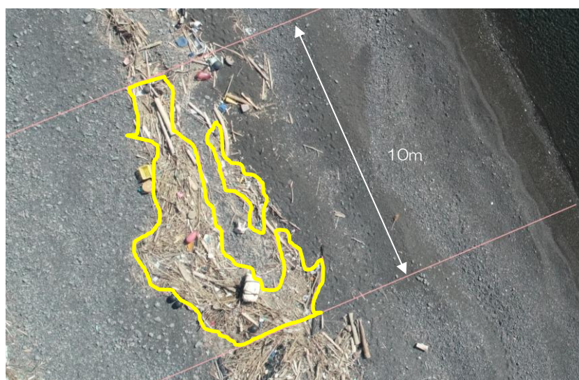
写真 2-9 4a2 ドローン撮影写真（面積 25 m 2 、自然ごみ以外の割合 10%）
