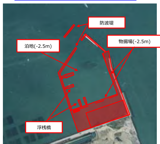
東予港小型船だまり整備
