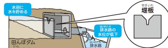
水路へ流れ出る量を調節する板を取り付け、ゆっくりと排水を流すことで、排水路の急激な水位の上昇を防ぎます。
