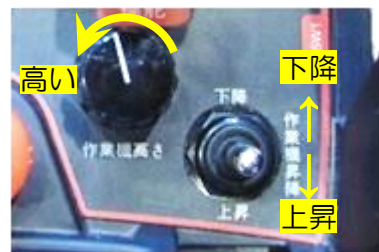
作業機昇降スイッチ
