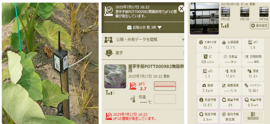
スマホにお知らせ「できるサトイモ栽培」支援システム (写真左：水分センサー、写真右2枚：スマートフォン画面)
