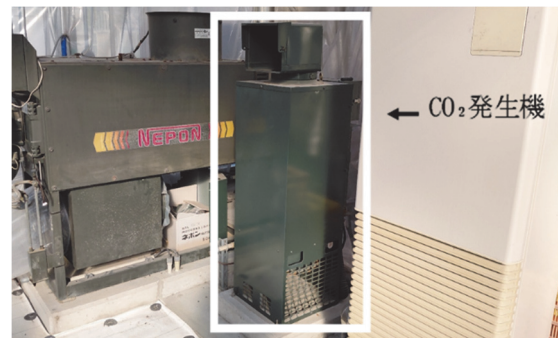
図3 燃焼ガス全体施用に用いたCO 2 発生機 (図中央，使用時ダクトなし) [53頁]
