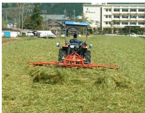
写真1 テッダーの反転は、刈取り後の水分含量が高いうちに1～2回行う。
