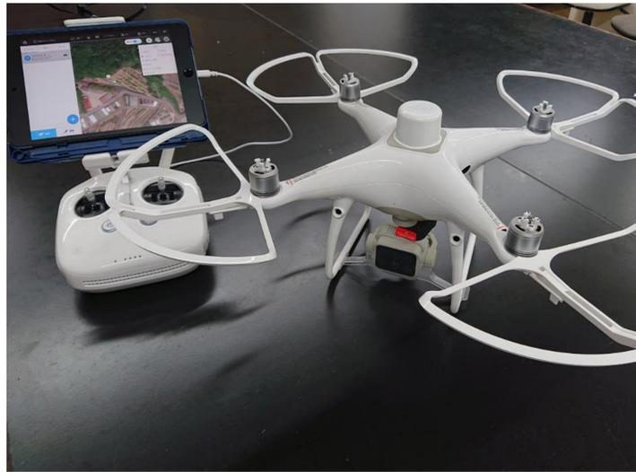
マルチスペクトルカメラにより、可視光、青(450nm)、緑(560nm)、赤(650nm)、レッドエッジ(730nm)、近赤外線(840nm)の波長で撮影が可能。近赤外線と赤の反射率よりNDVIを算出。
