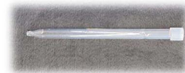
写真2 簡易検定手法に使用したパスツールピペットを加工した吸虫管
