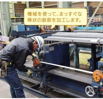
機械を使って、まっすぐに棒状の鉄筋を加工します。
