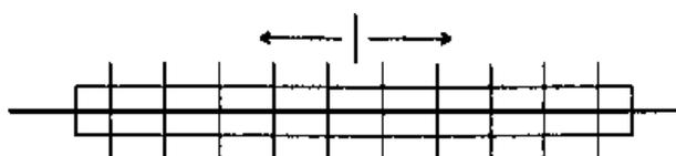
図 4 - 1 ボルト締付け順序
