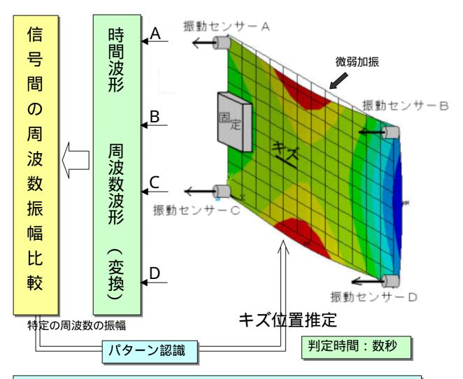
振動法によりキズの大まかな位置が特定できれば、CCDカメラによる検査時間を大幅に短縮できます。また、外見検査では分からない内部欠陥や材料異常についても知ることができます。
