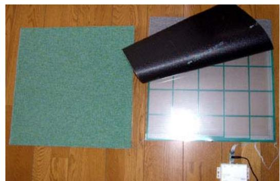
図2 感圧センサー利用所在検知システム
