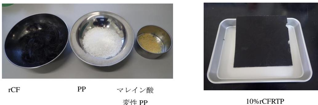
図8 回収したrCFとPPを複合化したrCFRTP
