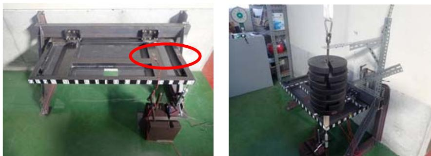
図7 ひずみゲージ取り付け箇所と試験風景
