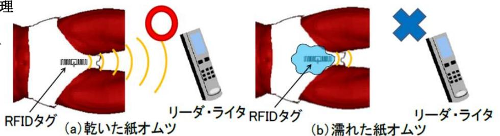
図 1 RFID における排尿測定の実験図
