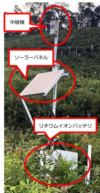
写真3：中継機の構成
