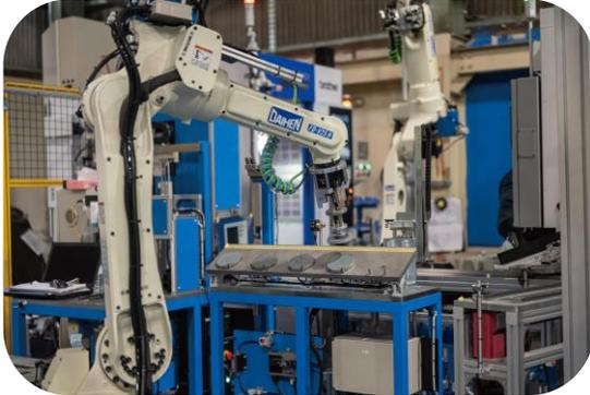
ロボット連動CNC旋盤
