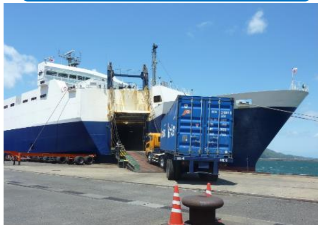
RORO船の荷役状況
